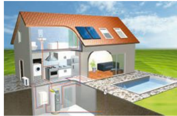
Pompa ciepła ROE-II połączona z podgrzewaczem solarnym Dietrich Trio
